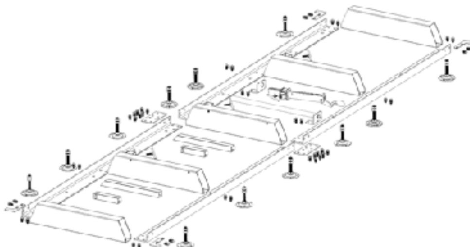
La piste devrait être assemblée de façon à avoir une largeur de 30,5 po (775 mm) mesurée de l'extérieur à l'extérieur des rails « L ».
