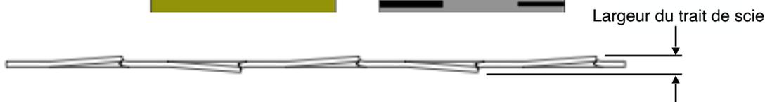
Les graduations sur l'échelle magnétique blanche tiennent compte de la largeur du trait de scie. Sur l'échelle magnétique jaune, la largeur du trait de scie n'est pas prise en compte dans les mesures.
