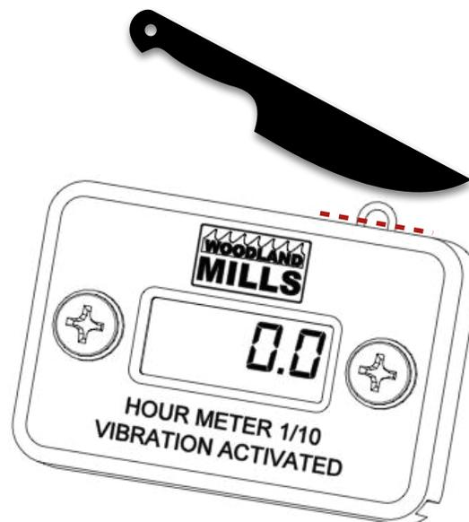
Coupez la boucle de fil sur le compteur d'heures après l'assemblage de la scierie
