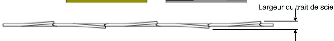
Les graduations sur l'échelle magnétique blanche tiennent compte de la largeur du trait de scie. Sur l'échelle magnétique jaune, la largeur du trait de scie n'est pas prise en compte dans les mesures.
